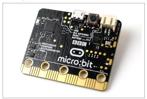
Figure 3-3. The back of the BBC micro:bit
